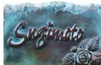
ブロンズ製品に銅錫である緑青を薬品を用い発生させるアンティークな趣向を表現する仕上げ方法。
